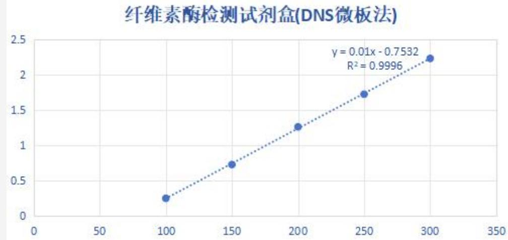
Leagene 采用酶标仪 540nm 测定，“0” 号管吸光度为 0.12 左右，呈黄色，100 $\mu\text{g}/\text{ml}$  以上呈棕红色并逐渐加深。测定结果显示，当葡萄糖浓度大于 350 $\mu\text{g}/\text{ml}$  时，OD 值开始偏离，当葡萄糖浓度在 100~300 $\mu\text{g}/\text{ml}$  以内比较合适，因此当测定结果明显偏高应稀释后再测。因测定仪器及操作手法等不同，测定结果可有一定偏差。
